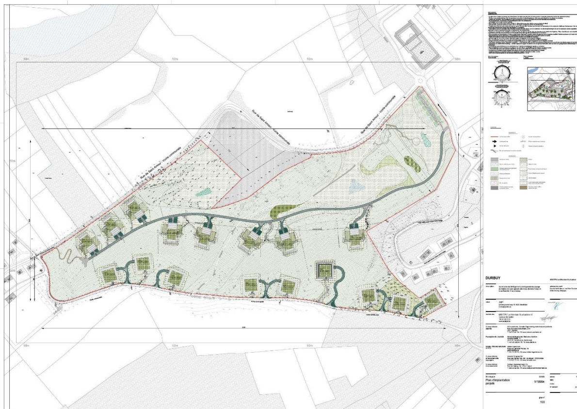
Figure 5: Plan d'implantation de l'avant-projet prévoyant l'implantation de 9 immeubles dits « Belvédères » situés sur les plateaux au sommet du périmètre, et 8 immeubles « Versant » intégrés à la pente naturelle du terrain.
